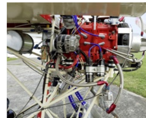
Das muss sein Redundante Doppelzündung und Untersetzungsgetriebe von Rotary Aviation (USA)
