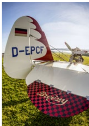
Aufgesetzt Weil die Breezy im Gegensatz zur PA-18 keine Flossen-trimmmung hat, braucht sie ein Flettnerrotor
