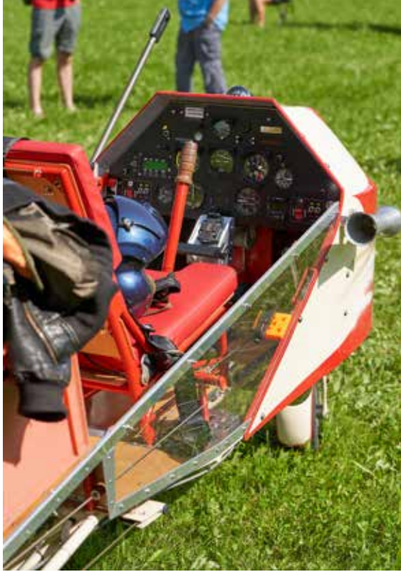
Jede Menge Avionik steckt auch aus Schwerpunktgründen im Panel der deutschen Breezy .
