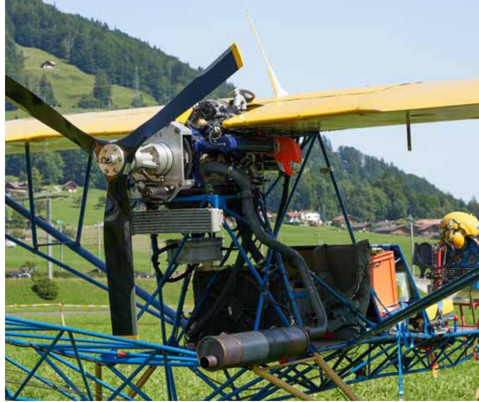
In der Schweizer Breezy steckt ein Mazda-Wankel-Motor mit Benzineinspritzung.
